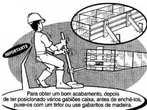
Figura 2.6 – Detalhe da utilização do tirfor ou gabarito.
