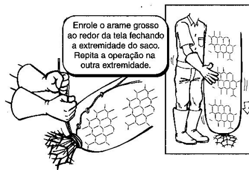
Figura 2.14 – Detalhe da conformação das extremidades do gabião tipo saco
