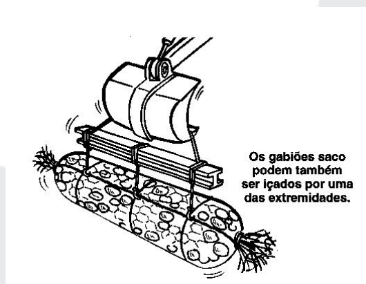
2.19 – Posicionamento dos pontos de içamento
