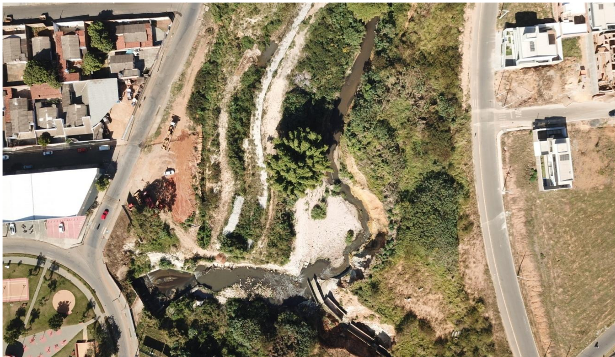
F-05 - Est. 45+00 Vista Superior da Rotatória da Morada Nova - Transição da Galeria Existente para o Novo Canal.
