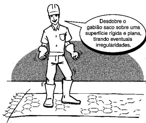
Figura 2.11 – Preparação de um gabião saco.
