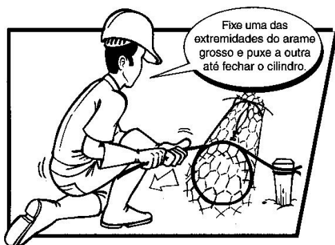
Figura 2.13 – Amarração e fechamento das extremidades gabião tipo saco.
