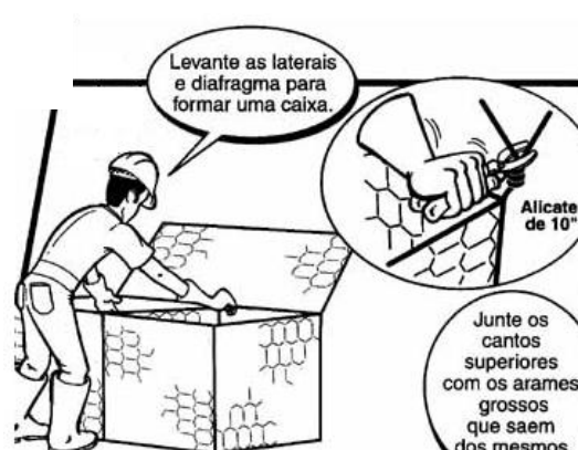
Figura 2.3 – Posicionamento dos painéis laterais e diafragmas.
