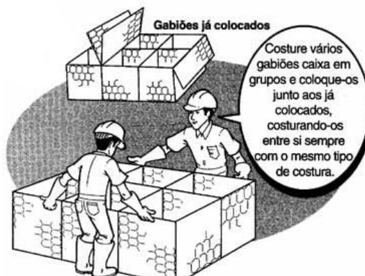
Figura 2.5 – Posicionamento dos gabiões antes de seu enchimento.
