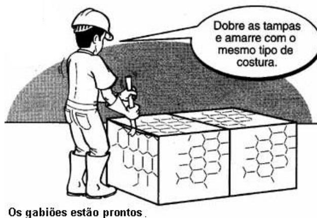
Figura 2.10 – Detalhe da etapa de fechamento do gabião tipo caixa.
