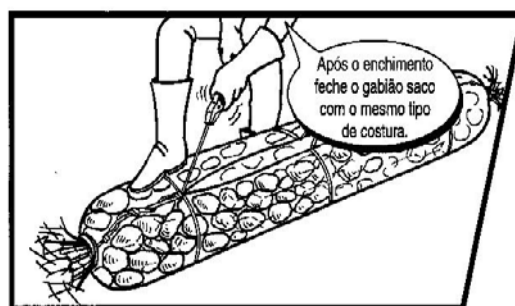
Figura 2.17 – Fechamento do gabião e fixação dos tirantes.
